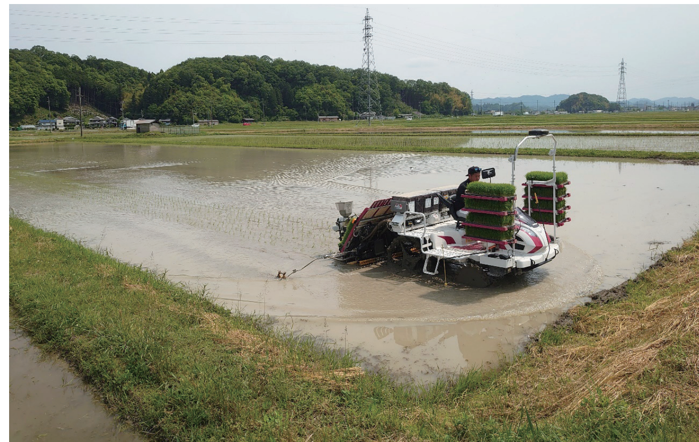
スマート農機と連携した田植え同時可変施肥の様子
