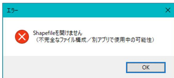
図第 VII-39 “shp” ファイルだけを読み込んだ場合発生するエラー
