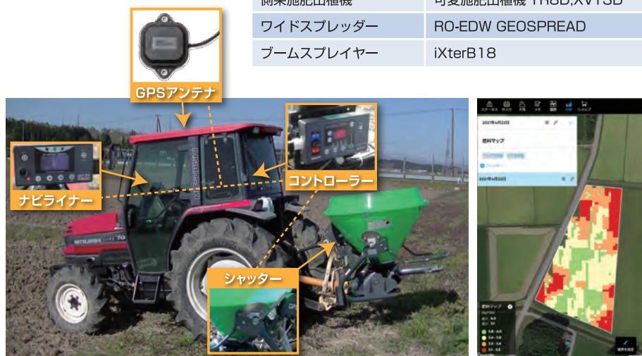
図3. GPSナビキャスタと実際に行った可変施肥の散布ログ
