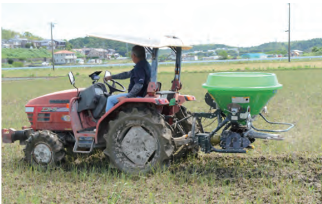
2021年からはGPSナビキャスターを試験導入し、可変施肥散布を行っている(写真提供:JA静岡中央会)
