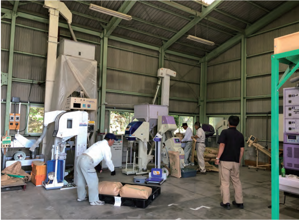
米の色彩選別の作業受託。フレコンで受け、選別後紙袋に入れ納品する
